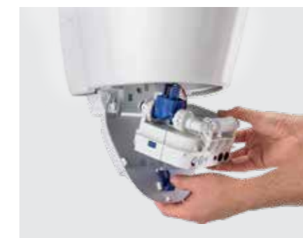
↑ Krmilna enota vsebuje infrardeči oddajnik in sprejemnik, električni priključek in elektromagnetni ventil ter se lahko odstrani z eno roko.
